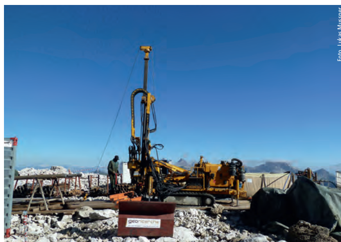
Das Bohrgerät mit welchem die Bohrungen am Blockgletscher Murfreit abgeteuf wurden.
